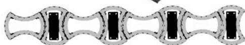
Mur oporowy z zazbrojonymi i zabetonowanymi rdzeniami, od strony frontowej z poziomami do obsadzania.
